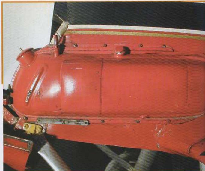
Le réservoir terminé avec tous les bouchons et toutes les têtes de vis à leur place, le marquage des rivets plats, les salissures à leur place, et la plaque d'identification
