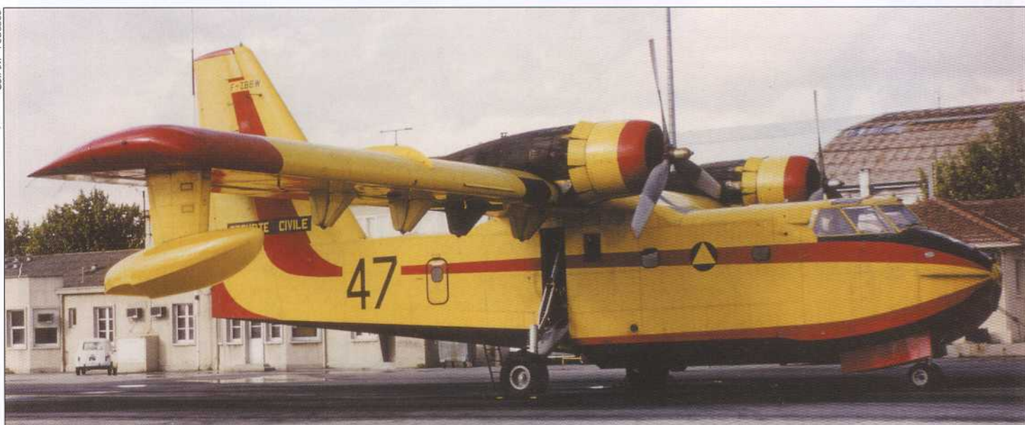
Seul bombardier d'eau conçu pour ce rôle, le Canadair trahit par ses lignes sa conception rustique. L'épaisseur de ses ailes est importante, en vue de lui donner de très bonnes performances de maniabilité à basse altitude et basse vitesse.
