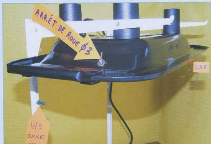
Détail de la fixation du barbecue sur les potences.
