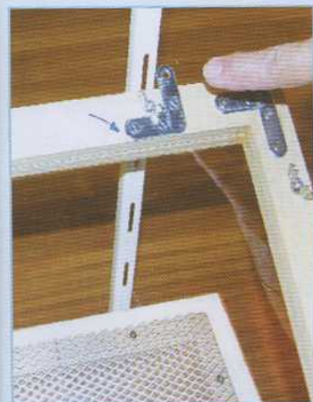
Le guidage du plateau lors de la descente, est assuré par des petites équerres.
