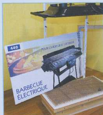
Un simple barbecue est utilisé ici pour chauffer les feuilles à thermoformer
