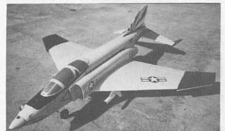
Le Phantom en semi-maquette : 1,31 m ; 37 dm 2 ; 2,85 kg ; 6,5 cm 3 .
