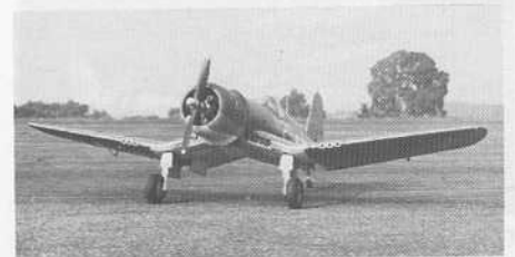
Le Corsair au 1/8 : 1,56 m ; 44 dm 2 ; 3,7 kg ; 7,5 à 10 cm 3 .
