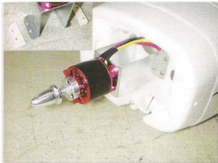
L'installation moteur montée d'origine. En médaillon, les cales ajoutées pour avancer l'hélice par rapport au capot.
