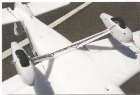
Le train principal est «bien habillé». Il a été verrouillé par des cales en balsa.
