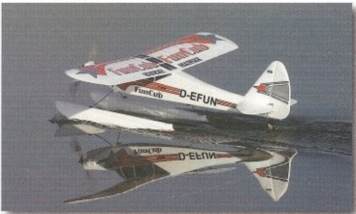
En navigation à basse vitesse, l'assiette est assez cabrée avec la roulette de queue qui frôle la surface.
