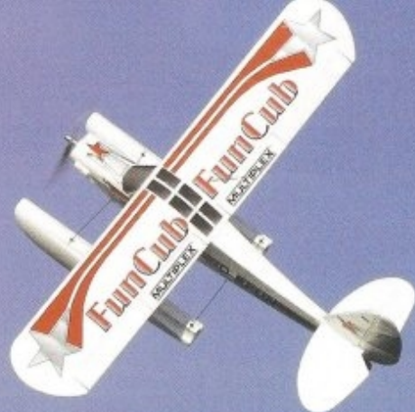
Le vol tranche avec flotteurs demande moins de braquage de la direction que quand les roues sont montées.
