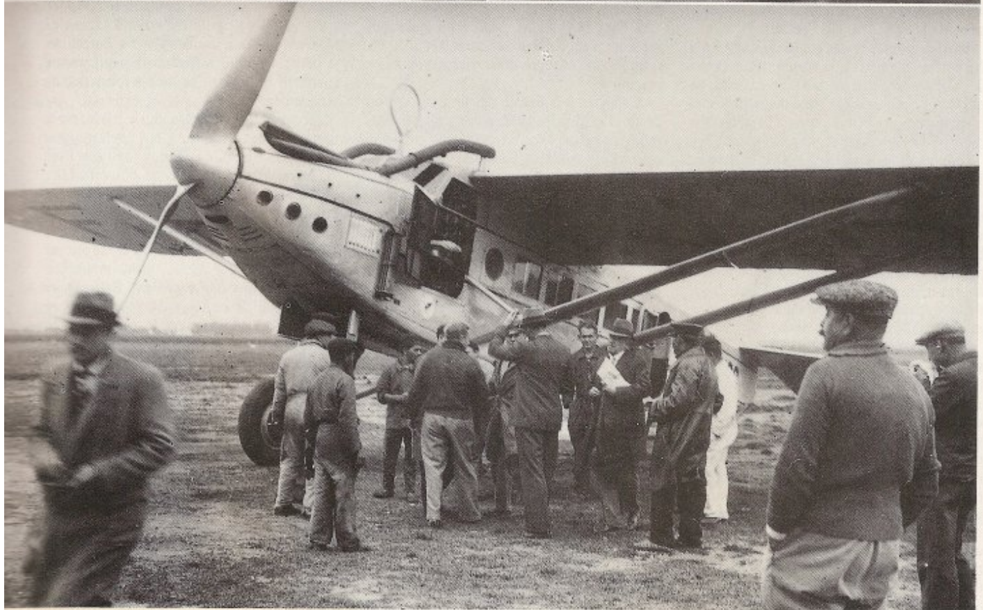
Page précédente : Le Laté 28-1 n° 907, F-AJF, à Toulouse, vers 1932, premier à avoir le pare-brise en pointe. Noter la modification des ouies du capot et la roulette de queue (Coll. Delmas). En haut à gauche : le Laté 28-1 n° 930 "Long-Courrier" Smara de la ligne Dakar-Koolak, à Dakar-Ouakam en 1937. En haut à droite : détail du Laté 28-0 n° 934 F-AJVH, en construction à Toulouse, en 1930. On aperçoit, au fond, deux flotteurs d'hydravion Laté 28-3. (Coll. Delmas). Ci-dessus : le Laté 28-1 n° 927 F-AJPC aux couleurs de la LANA, en Algérie, novembre 1935 (Photo Jarrige). Ci-contre : Le Laté 28/1, F-AJIX, à Toulouse en 1930. L'avion a été repeint en deux tons de vert (Voir notre numéro 286, page 18).
