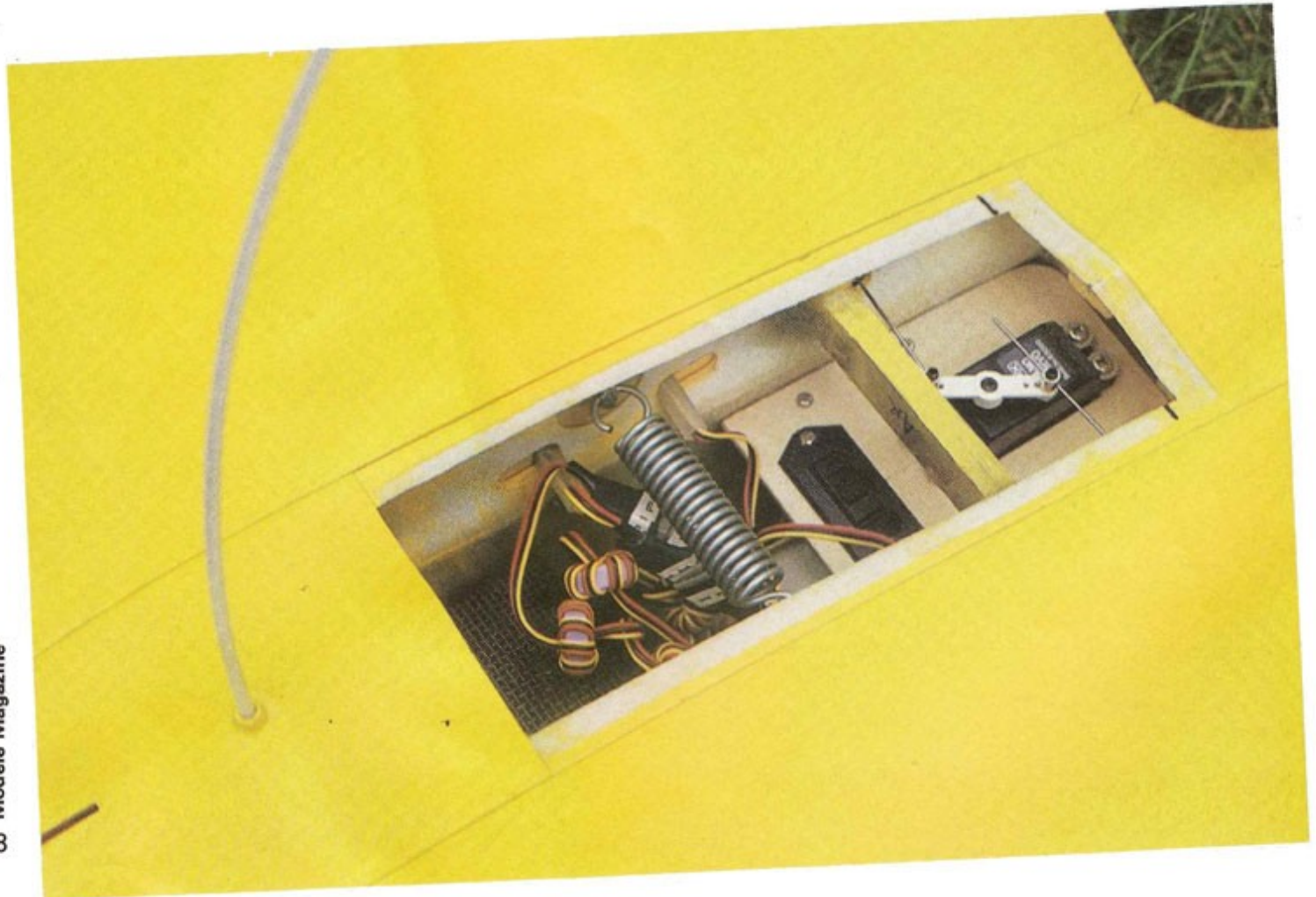
Notez ci-dessus le tube replié au-dessus du fuselage qui permet de loger l'antenne bien déployée. Ci-dessous le fuselage ne renferme en fait que deux servos : celui des aérofreins que l'on voit ici et celui du crochet de remorquage. Les servos d'ailerons et de profondeur sont logés dans les ailes et raccordés au récepteur via des rallonges dont une partie bobinée autour d'un tore en ferrite pour éviter tout parasite.
