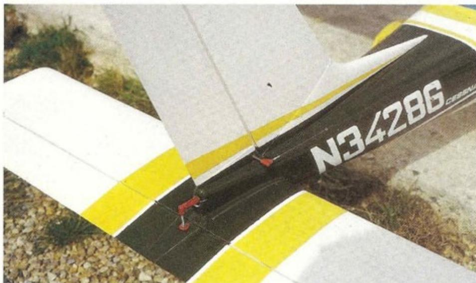
Des sorties de commandes discrètes pour la profondeur et la direction. Ci-dessous, la radio n'est pas franchement à l'étroit dans ce volumineux fuselage.
