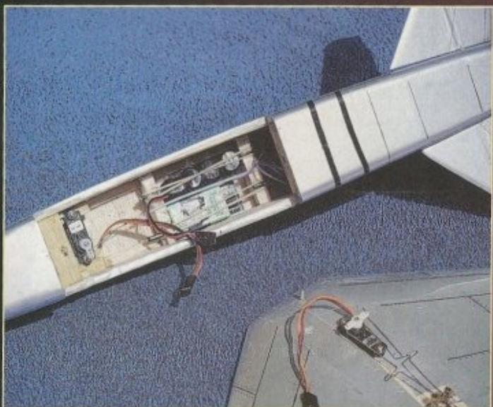
Pour la réception sont nécessaires deux sub-micros servos (ailerons et profondeur), un micro-récepteur et un accu de 110 mAh. Du matériel que l'on trouve aujourd'hui à des prix en rapport avec la taille du modèle.
