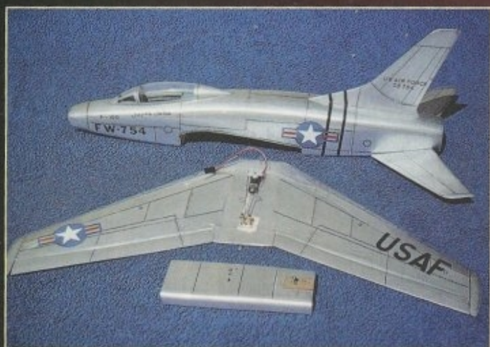
Le stab pendulaire n'étant pas démontable, l'avion se transporte en trois éléments : fuselage, aile et capot inférieur venant recouvrir le centre de l'aile. C'est pas du genre encombrant avec une envergure de 0,52 m et une longueur de 0,50 m !
