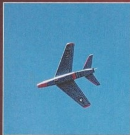
Le stab pendulaire n'étant pas démontable, l'avion se transporte en trois éléments : fuselage, aile et capot inférieur venant recouvrir le centre de l'aile. C'est pas du genre encombrant avec une envergure de 0,52 m et une longueur de 0,50 m !
