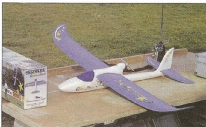
**Il faut trois heures de "travail" pour passer de la boîte, que l'on aperçoit à gauche de la photo, au modèle paré à voler. Notez au passage l'aérodynamisme des saumons, à la fois relevés pour aider le dièdre et effilés vers l'arrière pour réduire la traînée.**
