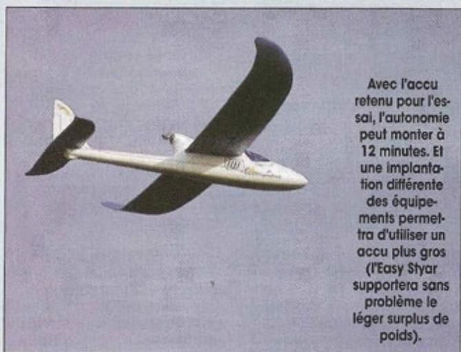
Avec l'accu retenu pour l'essai, l'autonomie peut monter à 12 minutes. Et une implantation différente des équipements permettra d'utiliser un accu plus gros (l'Easy Star supportera sans problème le léger surplus de poids).
