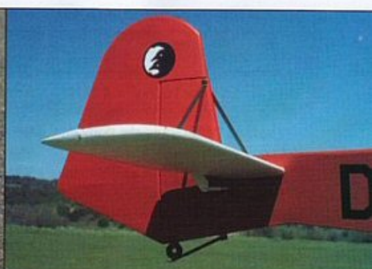
Gros plan sur l'empennage avant et après finition. Stab et dérive se construisent de façon similaire. Haubans et béquille suffisent à compléter le réalisme des formes.
