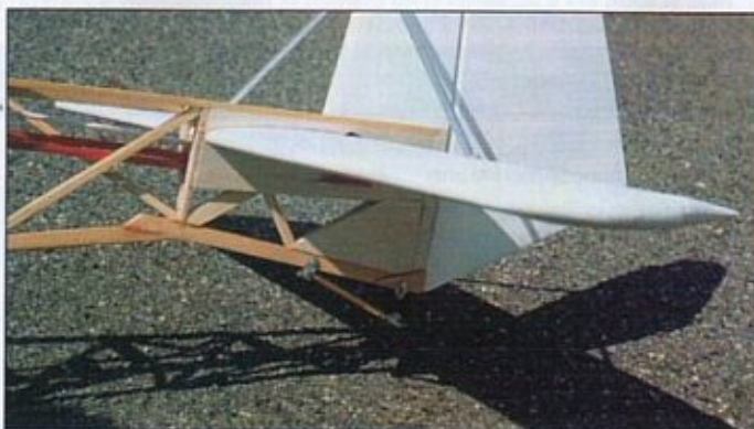
Gros plan sur l'empennage avant et après finition. Stab et dérive se construisent de façon similaire. Haubans et béquille suffisent à compléter le réalisme des formes.
