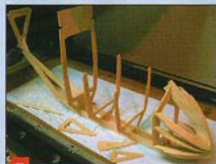
5 La précision des découpes permet un assemblage à blanc du fuselage sans colle, tout se tenant parfaitement bien.
