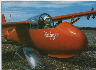
En un seul gros plan apparaissent toutes les "joyeuseries" de ce planeur ancien : aérofreins à palettes, habillage biplace avec deux verrières, haubans... A réserver aux poètes et aux contemplatifs !
