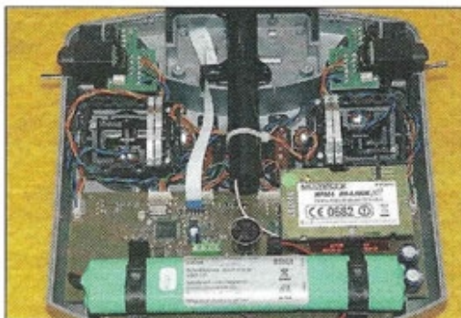
L'intérieur est identique à celui d'une Royal Evo ou d'une Royal Pro classique, mises à part la platine HF et l'antenne. L'accu assure pour sa part une autonomie phénoménale grâce à sa très faible autodécharge et à la sobriété de l'émetteur.
