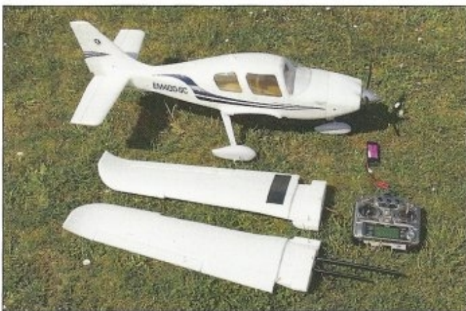
Il ne faut pas plus d'une heure trente pour passer du kit ARF «full-combo» à cette semi-maquette composée de trois éléments à assembler sur le terrain de vol.
