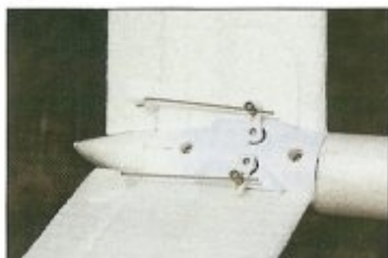
Le support du stabilisateur en Vé, moulé en plastique, intègre les servos «9g» montés avec leurs commandes.
