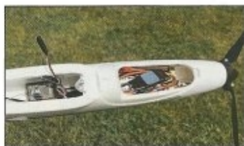
Dans le fuselage se trouvent, d'origine, l'ensemble de la réception ainsi que toute la propulsion.
