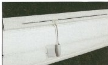
Chaque aileron est commandé par un servo (au format «9g»), livré en place avec sa commande et son cache.
