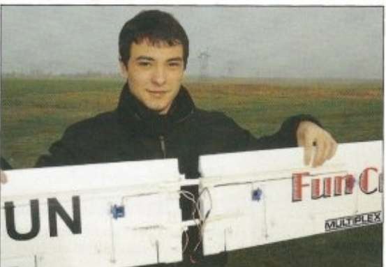
L'assemblage des deux ailes se fait vite et sans clé (ça évite de l'oublier...) grâce à la conception de leurs renforts.
