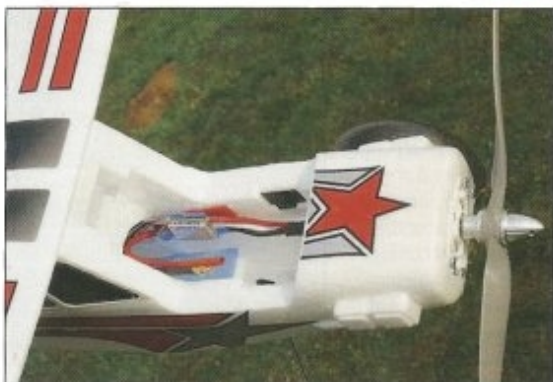
La dépose de la fausse verrière avant donne un accès aisé au logement du pack de propulsion 3S LiPo de 2000 mA.h.
