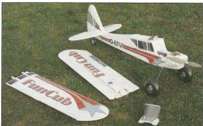
Les composants du FunCub sont moulés en EPP (c'est l'Elapor de Multiplex), un matériau bien adapté à ce type de modèle. Deux planches d'autocollants assurent une décoration agréable.
