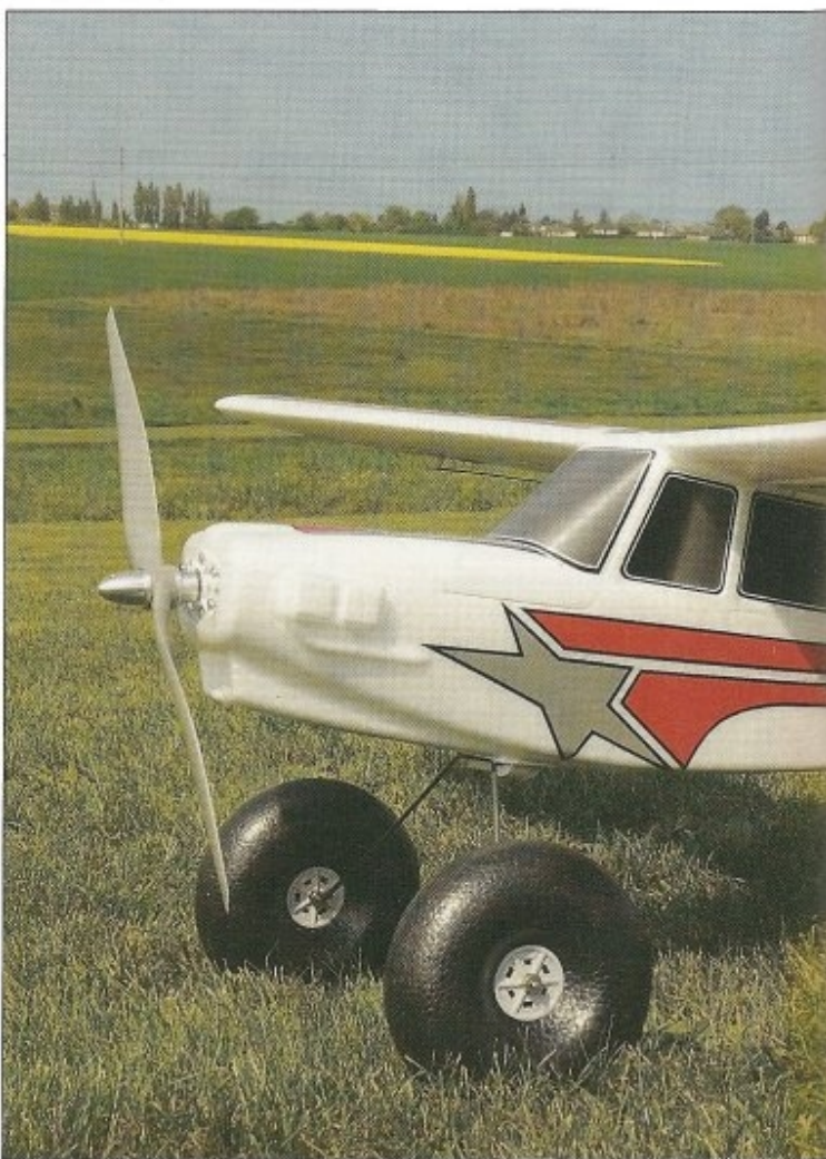
Les composants du FunCub sont moulés en EPP (c'est l'Elapor de Multiplex), un matériau bien adapté à ce type de modèle. Deux planches d'autocollants assurent une décoration agréable.
