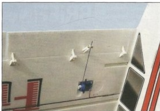
Les volets de courbure optionnels sont articulés sur des charnières à déport d'axe autorisant de large débattement.
