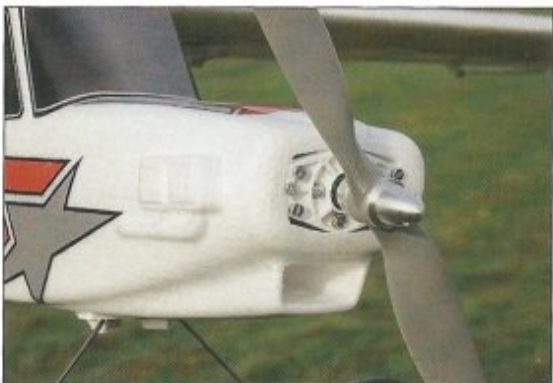
Le moteur est fixé par quatre vis sur un support en plastique lui-même maintenu sur le fuselage par deux vis.
