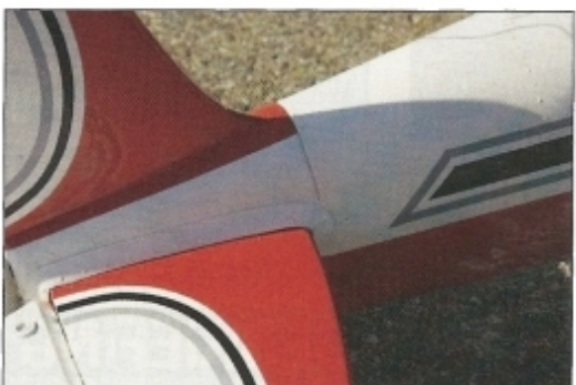
Il a fallu jouer du cutter pour trouver la place nécessaire au collage de la dérive sur le stabilisateur.
