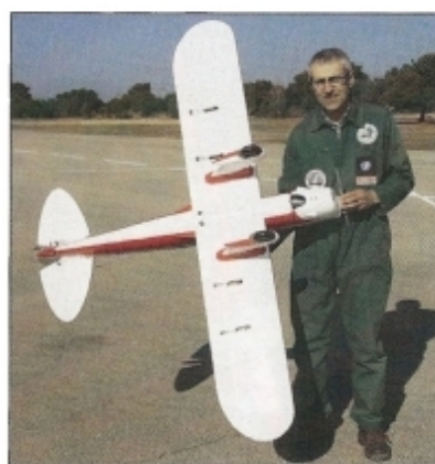
On voit à l'intrados les quatre servos des ailes dotées d'ailerons mais également de volets.
