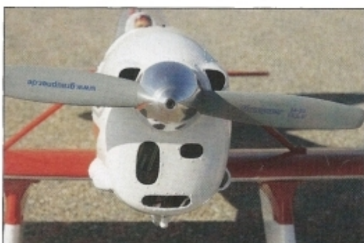
Les ouvertures frontales du capot-moteur sont découpées d'origine, ce capot abritant discrètement un OS 91FS.
