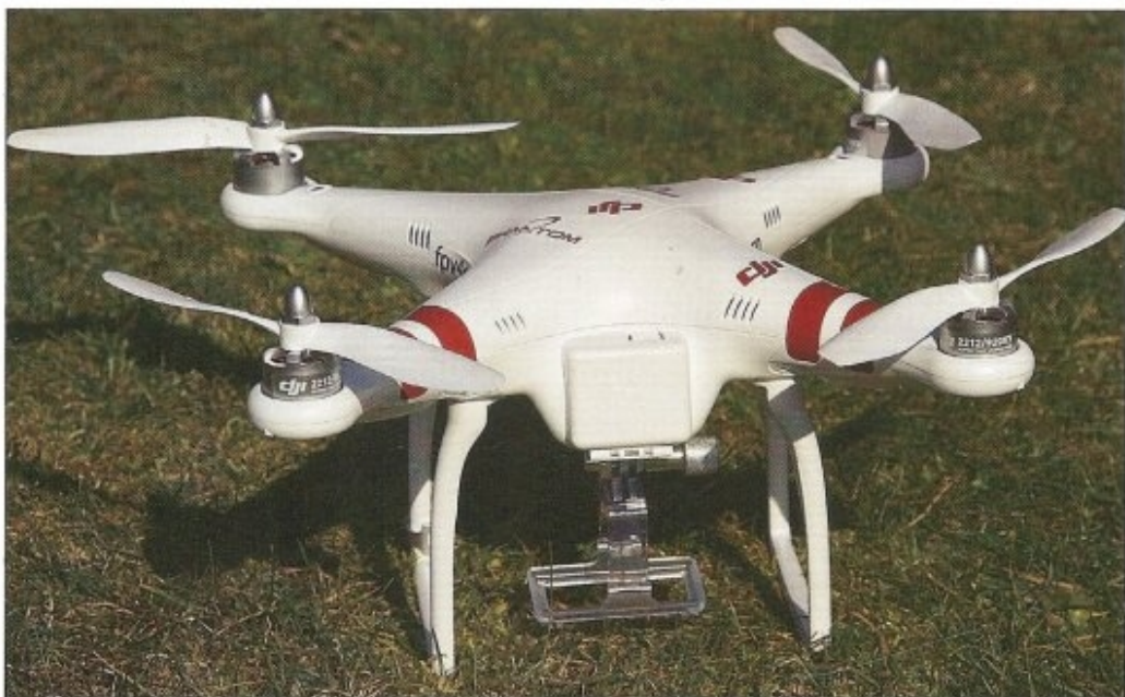
Il est obligatoire de monter le train qui donne cette allure un peu haut sur pattes. Cela permet de monter une caméra ou un appareil photo en-dessous et, surtout, on a la possibilité de décoller et d'atterrir sur de l'herbe haute.
