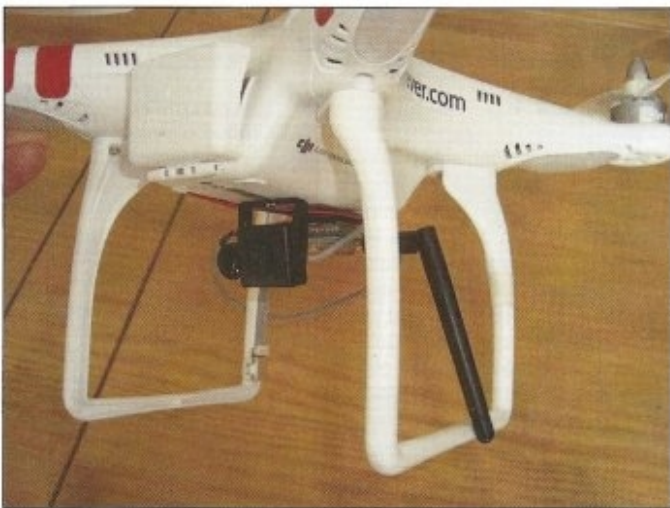
Le Phantom est une plateforme idéale pour s'essayer au vol en immersion (PFV) avec une petite caméra et un émetteur pour recevoir les images via des lunettes Fat Shark.
