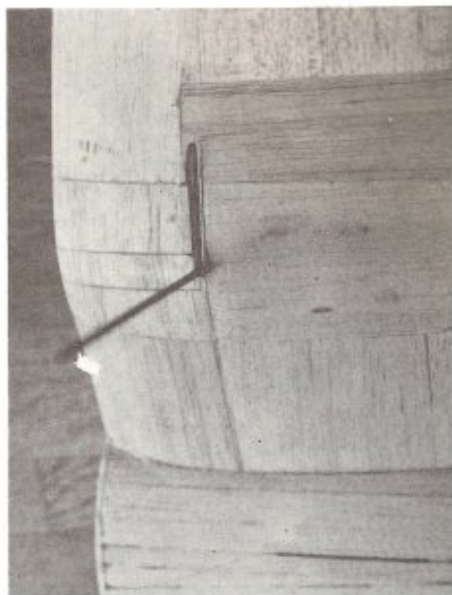
Le train d'atterrissage du proto a été déplacé sur le plan afin d'être conforme à la réalité. On remarque sur cette photo le sens des fibres des coffrages au niveau de N3 et N4.
