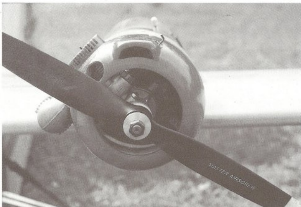
Moteur ASP 108 incliné à 45°, hélices 16 x 6.
