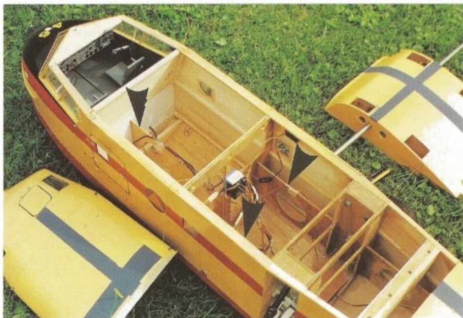
L'intérieur du Canadair. On peut voir la quille avant (flèches) et les deux renforts latéraux du train principal (flèches). On peut démonter le toit avant fixé par cinq vis, ainsi que la cabane qui supporte les ailes, ce qui donne une grande accessibilité à l'intérieur du fuselage.
