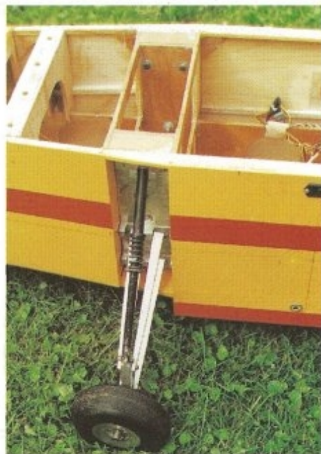
Le train principal provisoire avec son renforcement dans le fuselage, en noir l'amortisseur avec son ressort.
