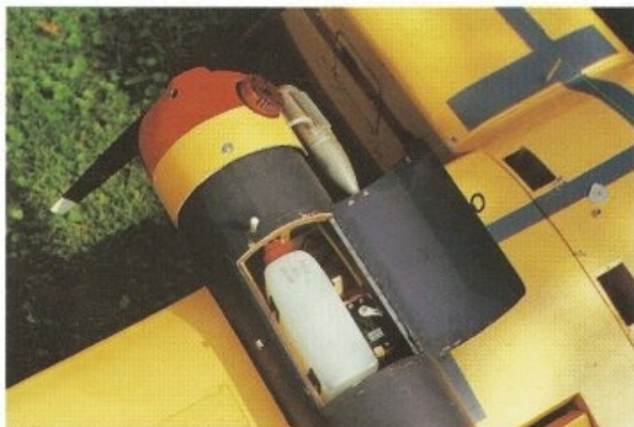
L'aile gauche avec son fuseau moteur capot ouvert, on voit le servo de gaz et le réservoir de 450 cm 3 donnant environ huit minutes de vol.
