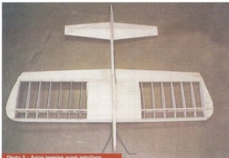
Photo 5 : Avion terminé avant entoilage.
