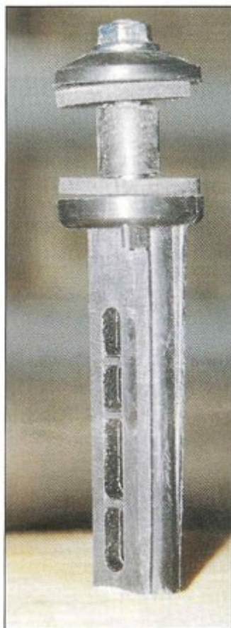
Un des éléments du bâti moteur avec les amortisseurs en caoutchouc.
