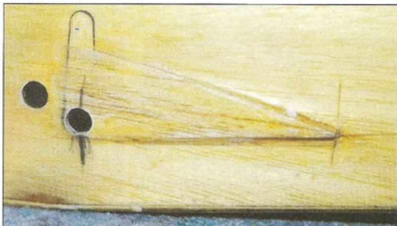
La petite modification concernant le passage de la commande des volets. On voit aussi le petit morceau de balsa sur lequel vient s'appuyer le bord de fuite de l'aile.
