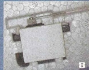
8 - Un cache-servo en balsa recouvert d'adhésif blanc (non fourni).
