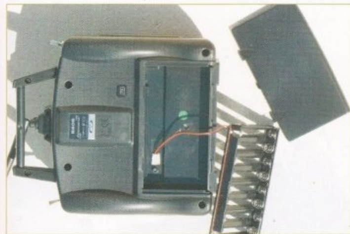
L'émetteur est livré avec un porte-piles. On peut y installer des batteries rechargeables, mais le mieux serait de se procurer le pack d'accus disponible en option.
