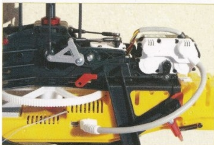
Côté droit, on distingue le palonnier du servo d'anti-couple et l'une des antennes du récepteur 2,4 GHz.
