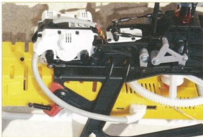
En blanc, le bloc servos 3 en 1, en jaune, le boîtier porte-accu et sa poignée rouge de verrouillage.
