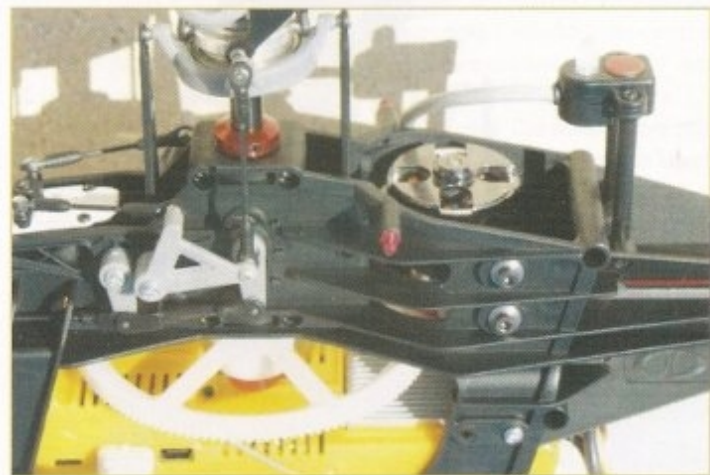
De droite à gauche, interrupteur de mise en marche, moteur et couronne d'entraînement, axe rotor, servo de latéral et renvoi ; à ce niveau, c'est encore classique.
