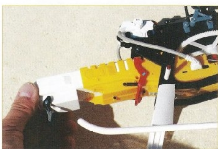
Pas besoin de déposer la carrosserie pour engager la batterie, puisque le réceptacle pivote.
