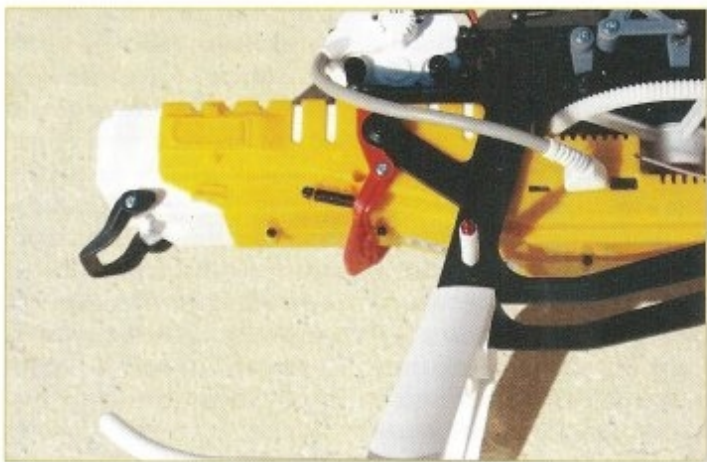
Ici pas de prise volante pour brancher l'accu, il suffit d'enfoncer entièrement le pack pour alimenter partiellement la machine (par sécurité, seules les commandes sont actives). Sur la photo, le pack de réception partiellement engagé une position bien pratique pour le transport.
