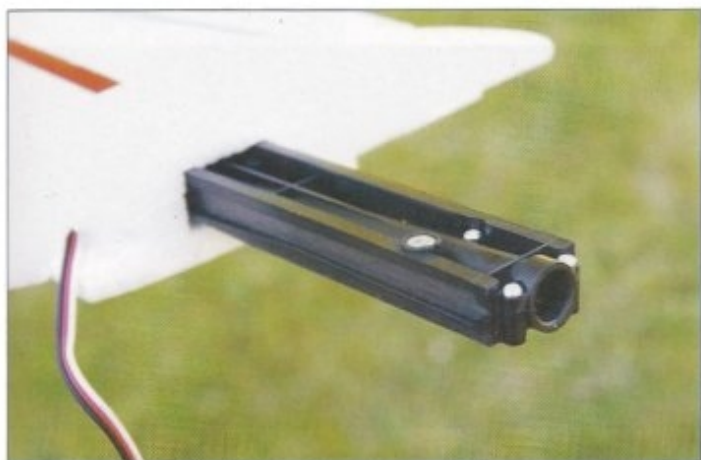
Les deux demi-ailes sont raccordées par une astucieuse pièce de liaison qui se fixe sur les deux tubes sur lesquels elle est stabilisée par serrage de deux vis de compression.
