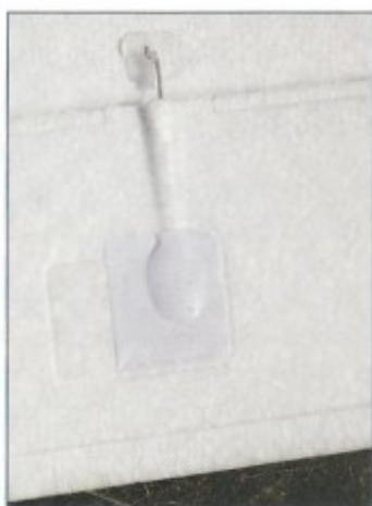
Les servos d'ailerons dépassent à peine à l'intrados, c'est bon pour la finesse tout ça !
