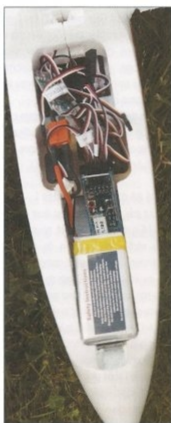
L'installation de l'électronique à l'avant du fuselage, la place est comptée !
