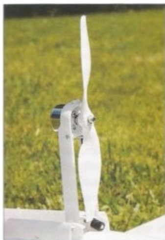
Le pylône en position sortie. Son système de sortie peut se faire selon deux processus logiques en fonction de la radio utilisée.
