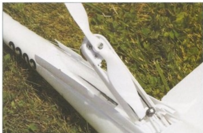
Lors de sa rétraction, le pylône marque un temps d'arrêt en position intermédiaire. Le doigt de freinage remonte et bloque l'hélice verticalement pour sa rentrée dans le puits.
