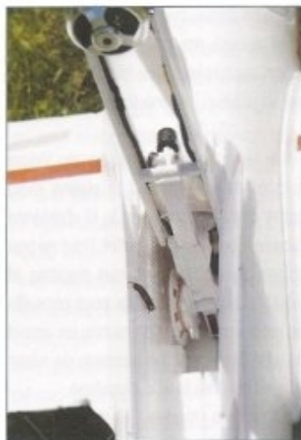
Une vue des entrailles de la bête : le mécanisme de rétraction proprement dit est composé essentiellement d'une poulie actionnée par un câble.
