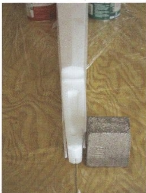
Pour un bon alignement du fuselage lors du collage des deux demi coques, l'auteur s'est référé à un axe tracé sur le chantier.
