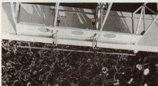
Détail du mécanisme interne de commande des aérofreins.
