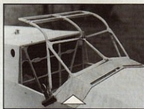
La conduite intérieure en cours de montage.
