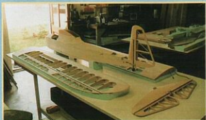
L'ensemble de la structure est terminée, il ne reste plus qu'à entoiler. Noter les chantiers d'aile en roofmat, au profil de l'intrados.
