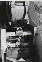
L'installation des servos de profondeur et de direction : c'est propre, net et sans bavures...
