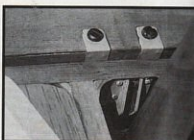
Fixation du stabilisateur par des ferrures comme le vrai et gignol de commande du volet de profondeur.
