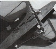
Détail d'un amortisseur du patin avant.
