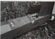
Comme sur le réel, le stabilisateur est fixé au fuselage par trois vis.
