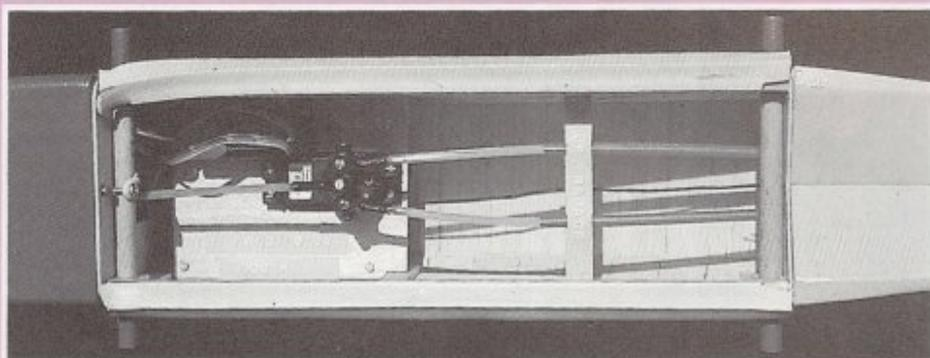
**Le rapace utilise un mélangeur mécanique pour le pilotage en deux axes. Rien de compliqué dans cet oiseau là !**
