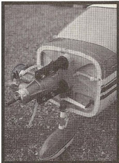
Capot enlevé, on voit bien le bâti très particulier qui porte le Rossi et le grand guignol de la roulette directrice, qui évite de trop louvoyer au décollage.
