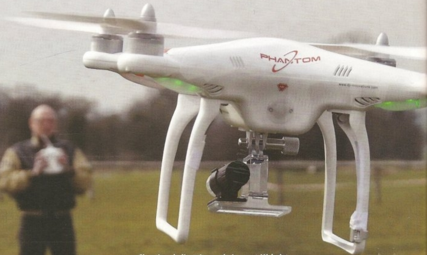
« Shooting de l'extrême » de Laurent Michelet qui défie ici le Phantom. A la base du train droit, le compas magnétique relié au GPS embarqué. Le connecteur sera protégé de l'humidité et des poussières par un adhésif étanche.
