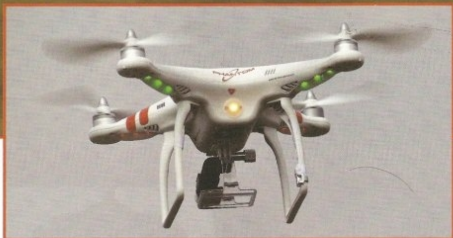
« Shooting de l'extrême » de Laurent Michelet qui défie ici le Phantom. A la base du train droit, le compas magnétique relié au GPS embarqué. Le connecteur sera protégé de l'humidité et des poussières par un adhésif étanche.
