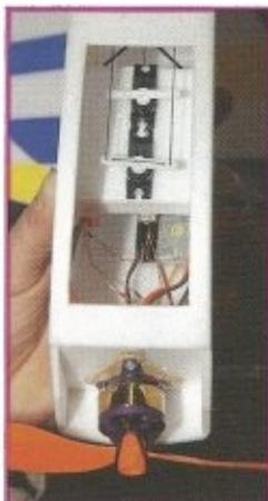
Les servos de profondeur et de direction sont placés à l'avant, centrage oblige.
