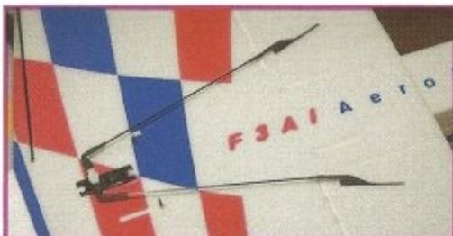
L'unique servo d'ailerons est placé à l'extérieur, à l'intrados de l'aile.
