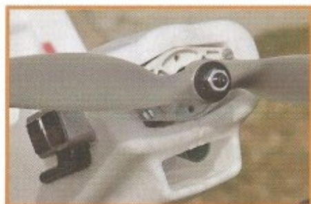
Une petite écope a été ajoutée qui canalise l'air frais sur le moteur.
