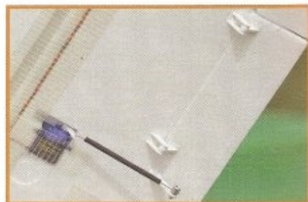
L'intrados de l'aile reçoit un "strapping" en scotch armé qui la renforce énormément.
