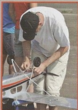
La trappe d'accès au pack d'accu se trouve sous le nez de l'avion, ce qui n'est pas très pratique.
