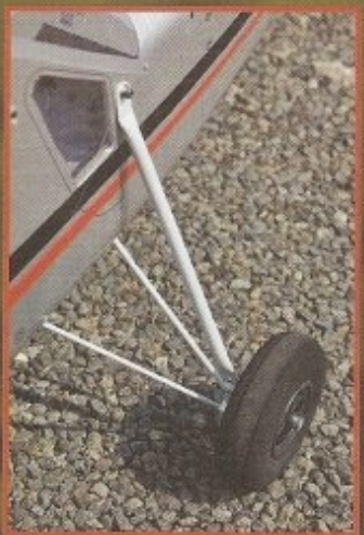
Le train n'est pas suspendu, ce qui rend les atterrissage un peu "Kangouresques"
