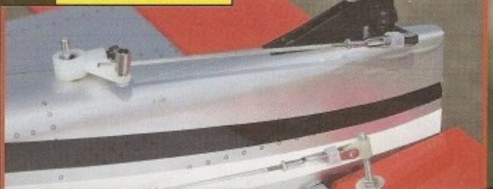
Le train n'est pas suspendu, ce qui rend les atterrissage un peu "Kangouresques"
