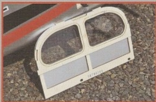
Original : la platine servos est amovible et on y accède par la porte latérale... qui est vissée !
