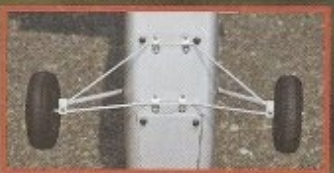
Le train n'est pas suspendu, ce qui rend les atterrissage un peu "Kangouresques"
