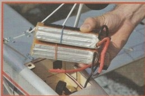
2 packs 3 S (réunis en 6S) de 4000 mAh, c'est déjà gros !
