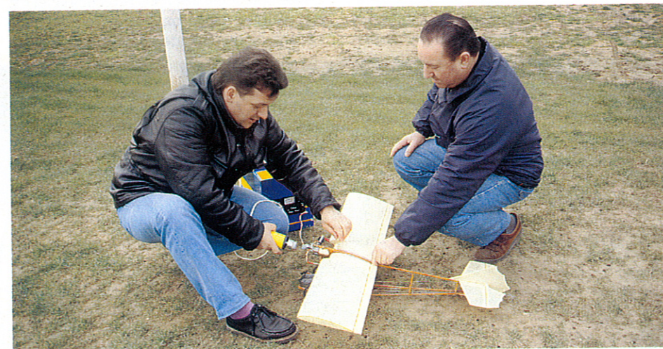
Un démarreur n'est pas inutile. Celui-ci a été fabriqué par l'auteur selon une « astuce » décrite dans la brochure « MRAstuces ».
