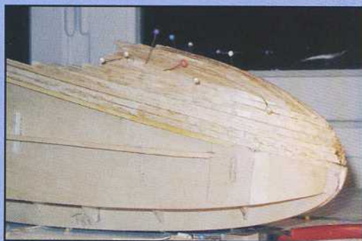
Vue sur l'avant du fuselage en cours de construction. Le capot avant est ensuite fibré (non obligatoire)
