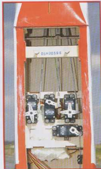
Le compartiment radio. Notez la présence de deux servos de profondeur...
