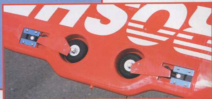
Le T6 Aeroshell est livré avec un train fixe, mais également un train rentrant mécanique qui devra être monté par vos propres soins. Les logements un peu petits rendent le T6 court sur patte...
