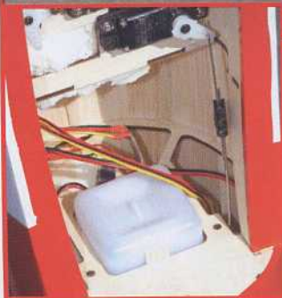
Le réservoir de 250 ml est un peu petit pour le 90 4 temps... Qui lui est un peu gros pour l'avion !
