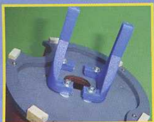
Bâti moteur monté en oblique sur le couple pare-feu.
