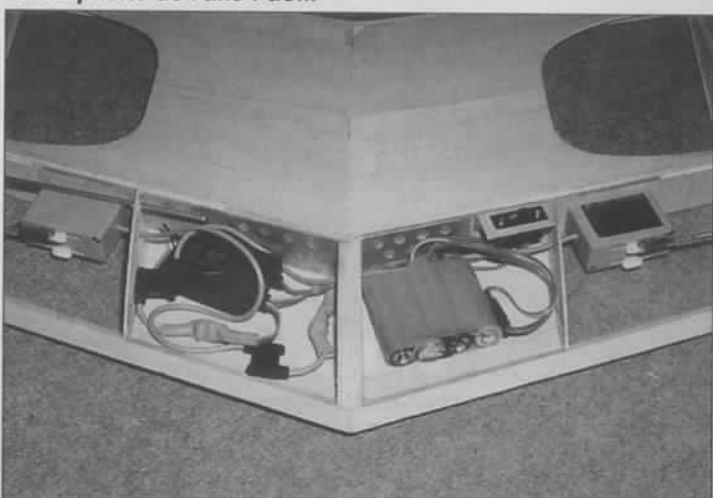
Toute la radio tient dans l'épaisseur de l'aile.
