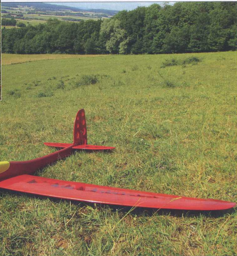
Malgré sa faible charge alaire (31 g/dm 2 ), l'Akhénaton est un voltigeur qui a de très bonnes capacités d'accélération grâce à son profil TP29-9. Et ses lignes sont plutôt élégantes, non ?
