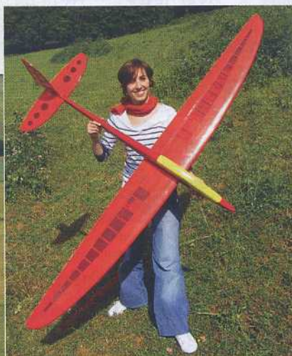
Malgré sa faible charge alaire (31 g/dm 2 ), l'Akhénaton est un voltigeur qui a de très bonnes capacités d'accélération grâce à son profil TP29-9. Et ses lignes sont plutôt élégantes, non ?
