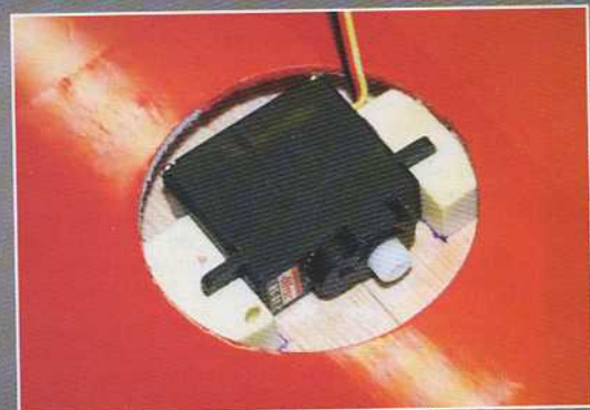
Chaque panneau d'aile externe reçoit un servo immobilisé grâce aux plots en mousse PU.
