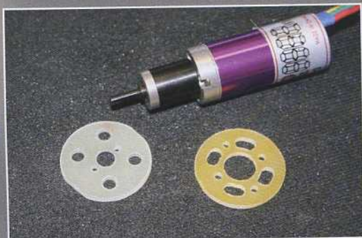
Visible à gauche, le couple de fixation moteur à été refait en plaque époxy, aux cotes de montage du réducteur Feigao.
