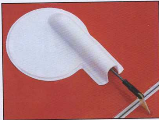
Les palonniers de servos sont protégés par des caches en plastique profilés.
