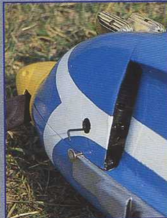
La ventilation du moteur est assurée grâce à de larges ouïes latérales.
