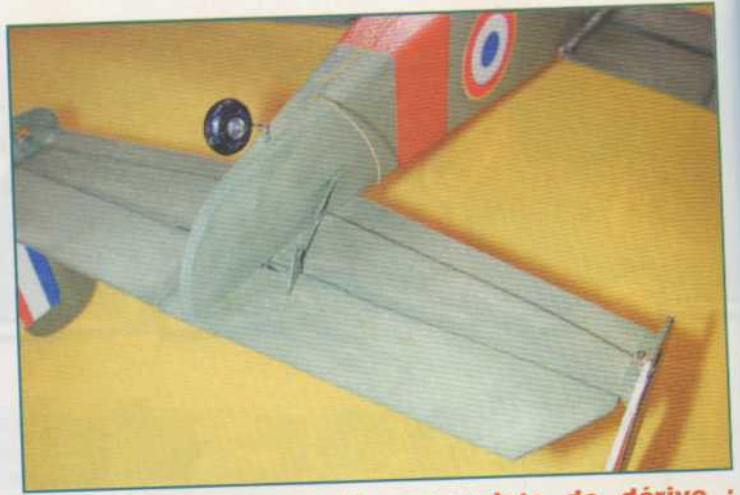
La roulette est couplée au volets de dérive : Pratique pour taxier.
