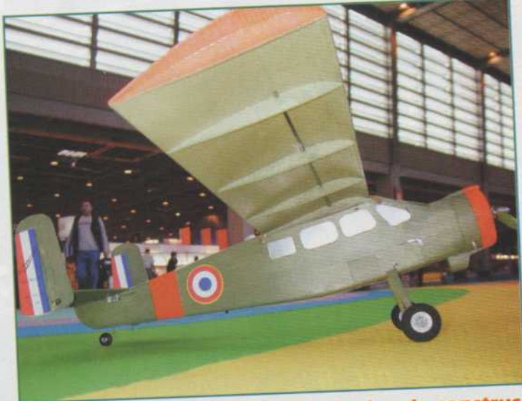
Vu de côté, l'aile dévoile son principe de construction, et la manière dont est roulé le Dépron.
