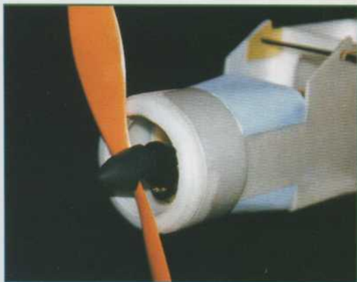
Le capot circulaire reçoit un anneau en Dépron poncé.
