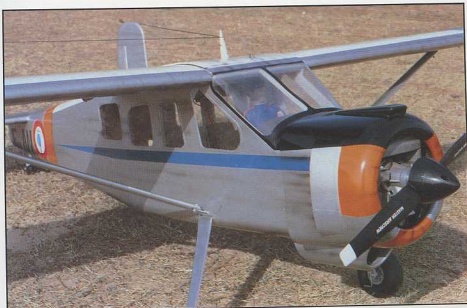
Le capot moteur est celui des premières séries (carénage de radiateur d'huile et prise d'air supérieure longs).
