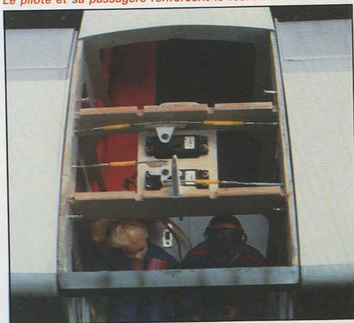
Installation des servos commandant les volets et les ailerons. Le pilote et sa passagère renforcent le réalisme.
