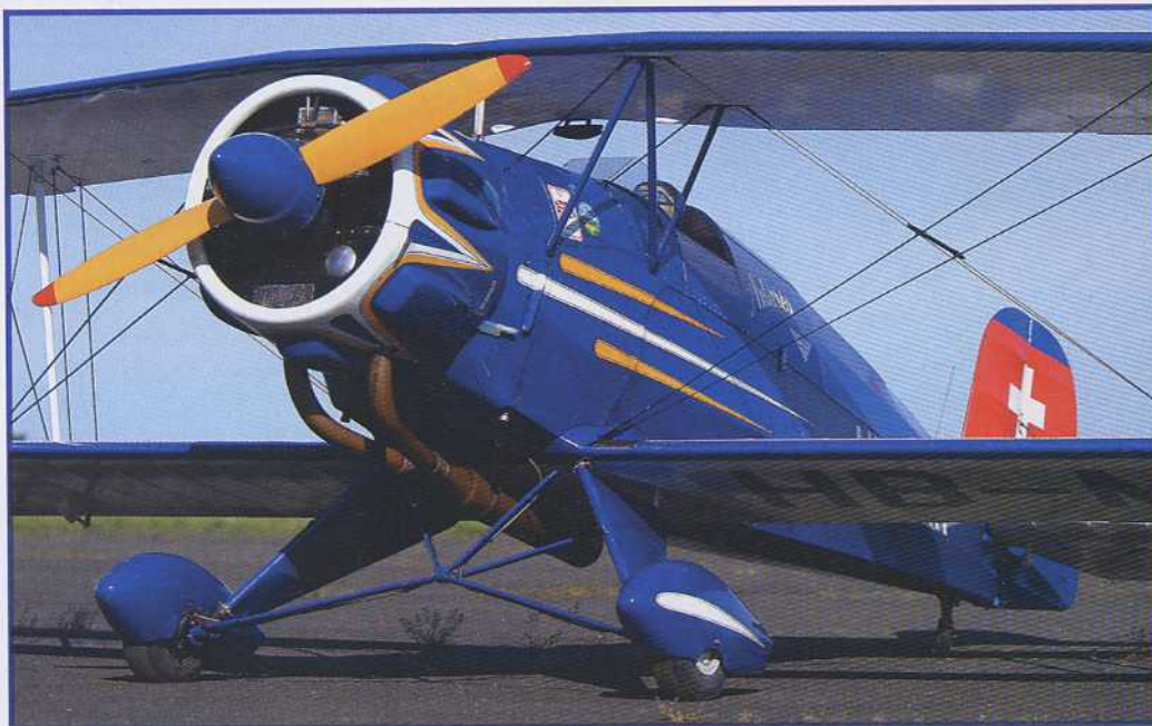
Le faux moteur, forcément hyper détaillé (vous noterez au passage que l'avion sujet n'était pas équipé du moteur en étoile d'origine) cache un Titan 62 cc adapté pour tourner au méthanol...
