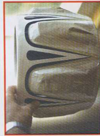
Forme de capot en mousse qui sera surmoulée. En bas, en peinture....
