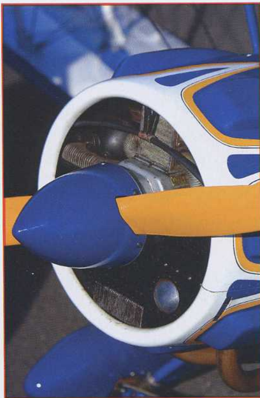
Le faux moteur, forcément hyper détaillé (vous noterez au passage que l'avion sujet n'était pas équipé du moteur en étoile d'origine) cache un Titan 62 cc adapté pour tourner au méthanol...
