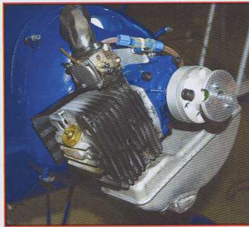
Le faux moteur, forcément hyper détaillé (vous noterez au passage que l'avion sujet n'était pas équipé du moteur en étoile d'origine) cache un Titan 62 cc adapté pour tourner au méthanol...
