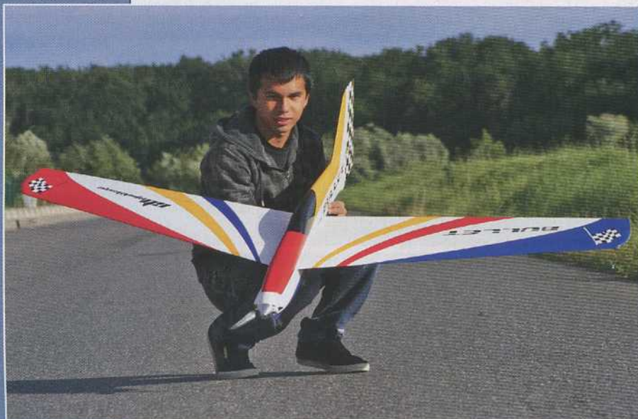
Notre pilote donne l'échelle. Avec une surface de près de ½ m², la Bullet n'est pas un petit modèle.
