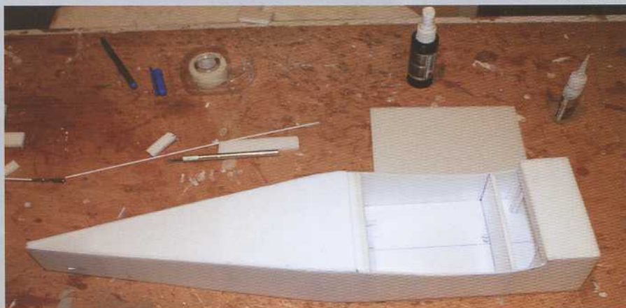
La structure de base du fuselage est une simple caisse en Dépron® très rigide et facile à construire
