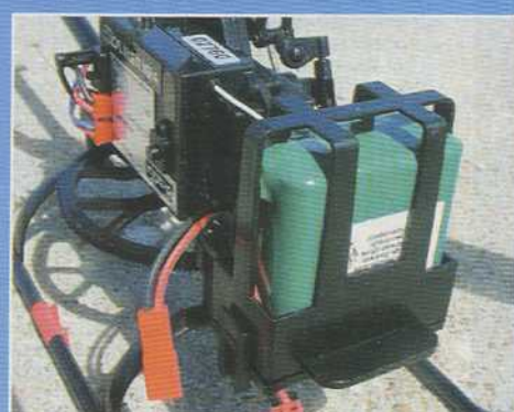
L'accu est un 8 éléments Ni-Mh de 900 mAh.
