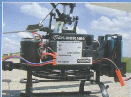
Le boîtier électronique renferme récepteur, gyro et double variateur.
