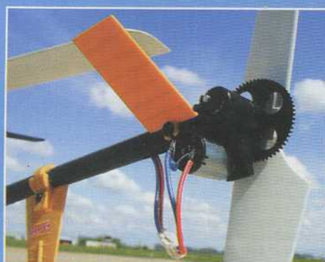
Le rotor anticouple possède son moteur dédié.
