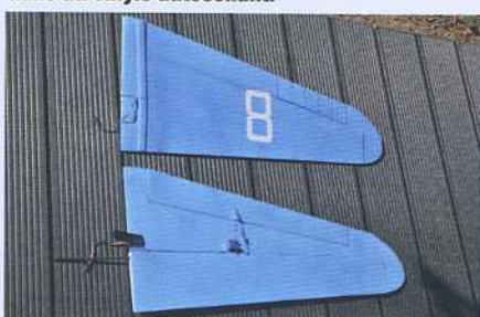
La voilure est démontable en deux parties et le verrouillage est simplement assuré par une bande de Velcro.
