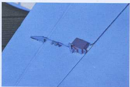
Les servos d'aileron sont simplement collés à l'intrados, les commandes sont courtes en corde à piano et les guignols en plaque PVC de 1 mm.
