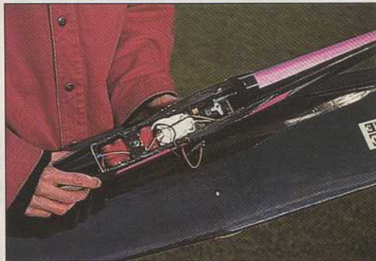
Grâce à une taille de fuselage pas trop réduite, l'installation des équipements - radio et propulsion - se fait aisément. Il n'y a qu'un servo, celui de profondeur (celui des ailerons est fixé au centre de l'aile), et l'accu de 7 éléments n'est pas très volumineux.
